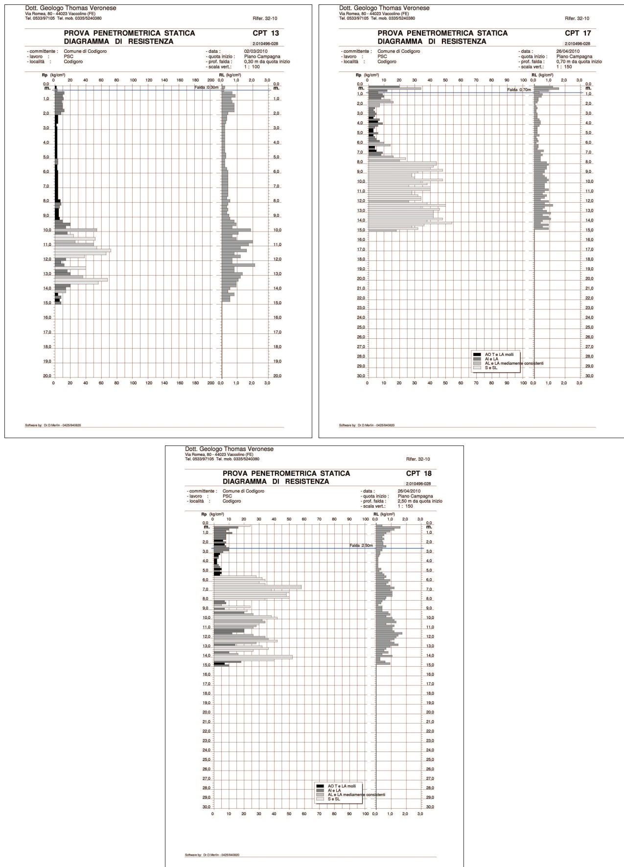
FIGURA 2.1.7 - Diagramma di resistenza delle prove penetrometriche
