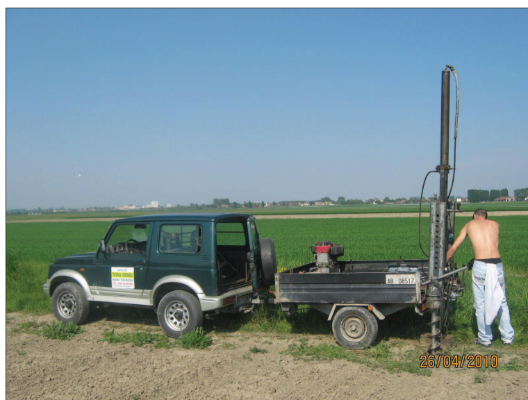
FIGURA 2.1.4 - Fase di esecuzione prove penetrometriche
