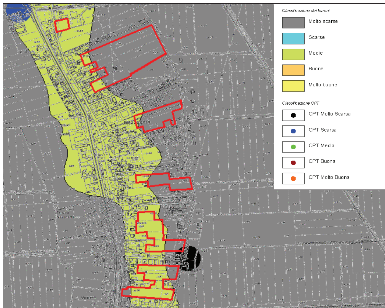
FIGURA 1.1.5 - Carta qualità geotecniche scala 1:10.000
