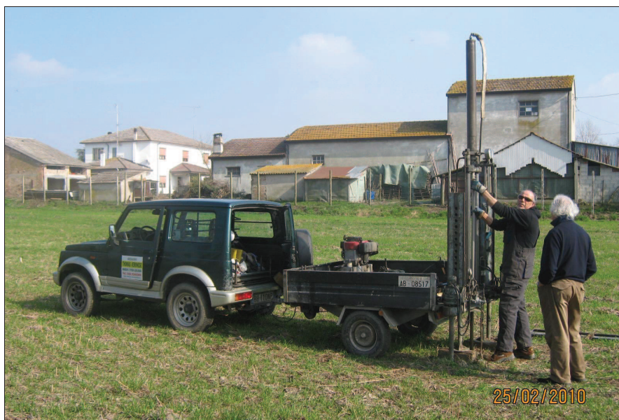
FIGURA 8.1.4 - Fase di esecuzione prova penetrometrica CPT3
