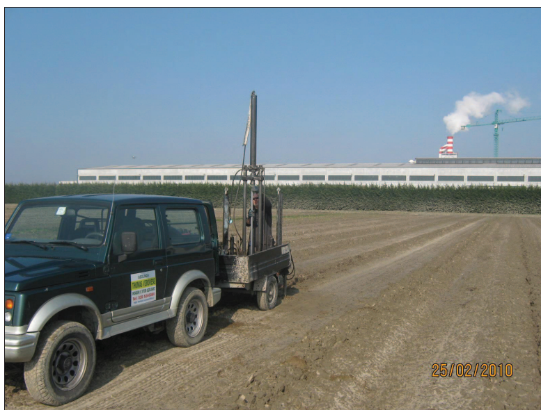
FIGURA 15.1.4 - Fase di esecuzione prova penetrometrica CPT2
