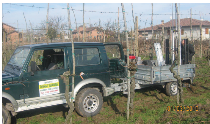
FIGURA 13.1.4 - Fase di esecuzione prova penetrometrica CPT6
