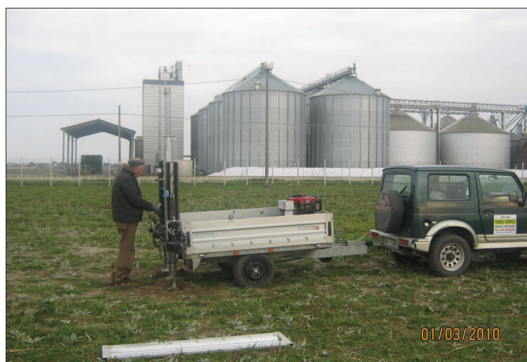
FIGURA 17.1.4 - Fase di esecuzione prova penetrometrica CPT9
