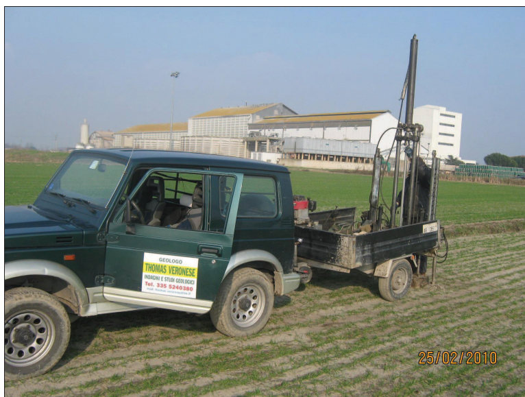
FIGURA 16.1.4 - Fase di esecuzione prova penetrometrica CPT4
