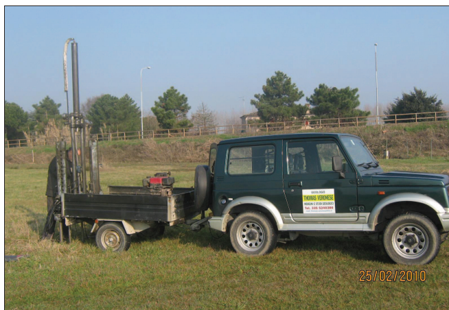
FIGURA 14.1.4 - Fase di esecuzione prova penetrometrica CPT1
